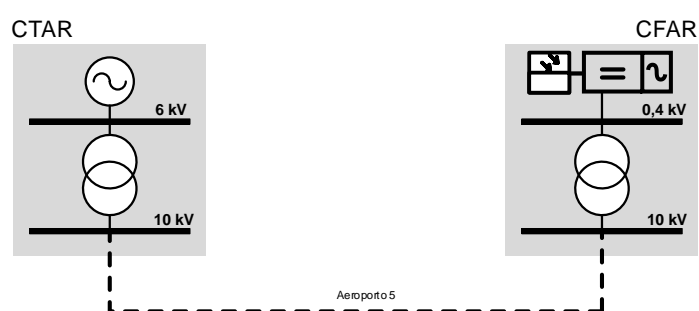
Figura 6- Esquema unifilar da rede de transporte
